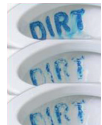
Descarga que limpia sin eliminar la totalidad de residuos.
