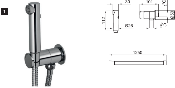
1 ROUND - Set ducha sanitaria. Incluye ducheta, flexible de 120cm doble grapado y llave de paso con soporte y función autocierre
