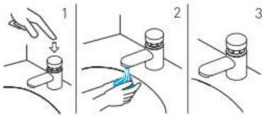
Orientación de Funcionamiento Apertura con Leve Presión Manual y Cierre automático
