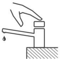
Orientación de Funcionamiento Apertura con Leve presión Manual y Cierre automático
