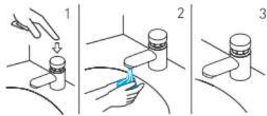
Orientación de Funcionamiento Apertura con Leve Presión Manual y Cierre automático
